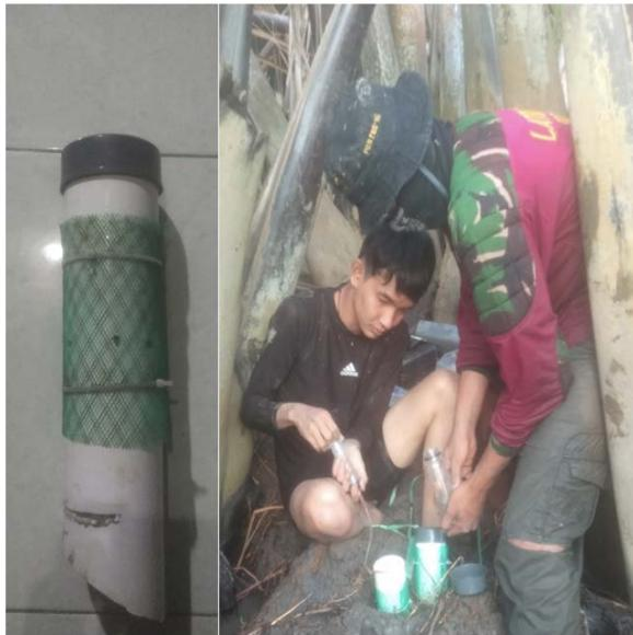
Gambar 2. Alat *pore water sampler* dan proses pengambilan sampel setelah 3 hari penanaman (De Karo, 2021)
