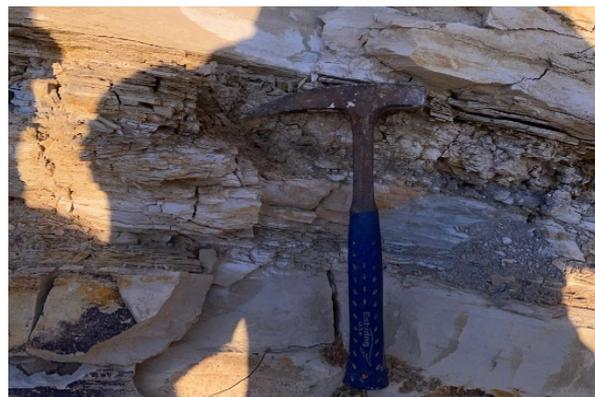
Foto 1. Singkapan Litofasies *Alternating Calcarenit and Shale*
