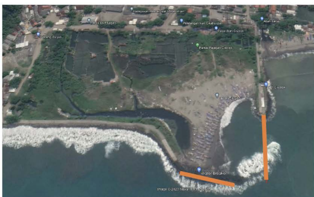
Gambar 3. Desain Alternatif Groin (Alternatif 1 -kiri dan Alternatif 2- kanan)
